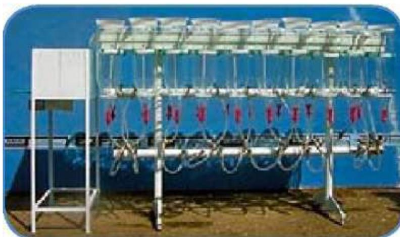
На предприятии разработан и выпускается ряд инкубационных стоек с аппаратами Вейса, отличающихся друг от друга только количеством аппаратов. Предназначены для обесклеивания икры и инкубации икры карпа, сиговых рыб и других, икра которых при инкубации находится в состоянии постоянного движения. В стойках имеется возможность регулировки расхода воды в каждом аппарате. Инкубационные стойки применяются при инкубации икры заводским способом (в инкубационных цехах).
