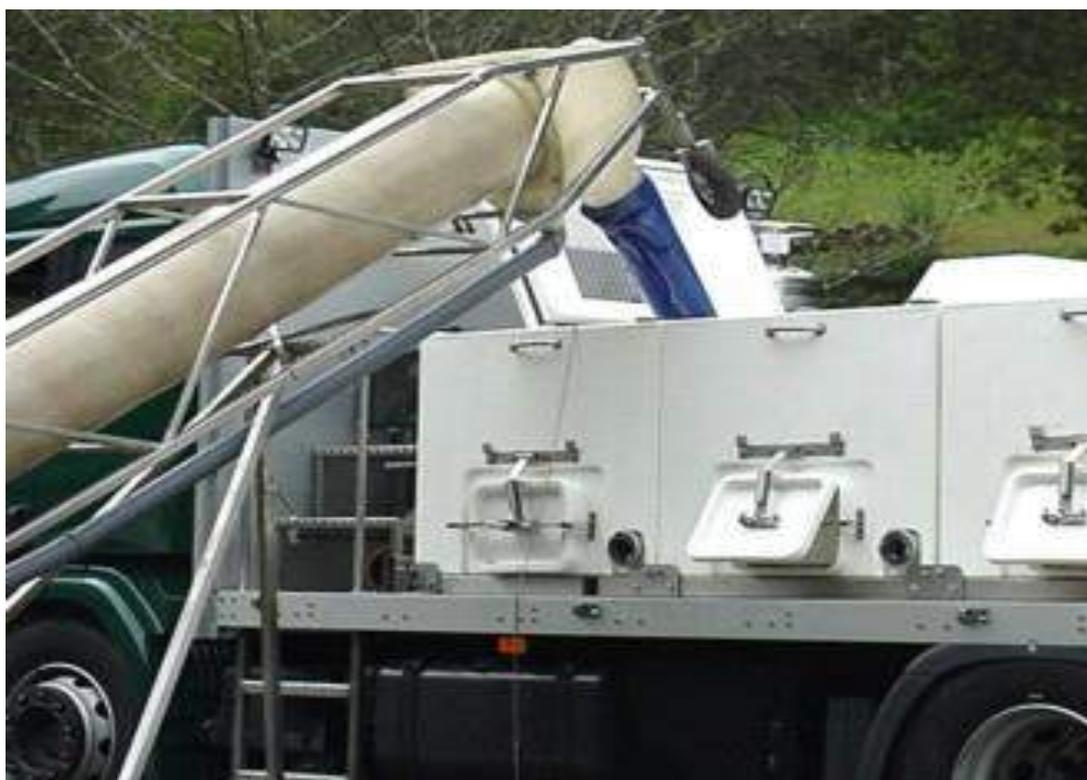
Рисунок - Шнековый рыбоподъемник
